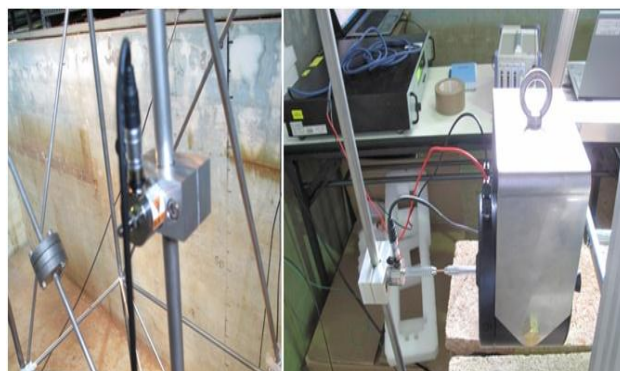
شکل ۲- ارتباط بین آمپلی فایر، لرزاننده الکترونیکی، نیروسنج و سازه ی مدل
