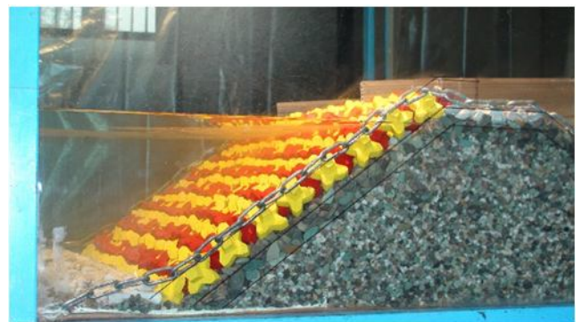
شکل ۱ - هندسه موجشکن ساخته شده در آزمایشگاه دانشگاه تربیت مدرس
