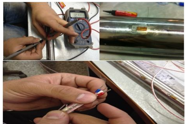
شکل ۱۰- مراحل آماده‌سازی و نصب کرنش‌سنج‌ها بر روی بدنه شمع
