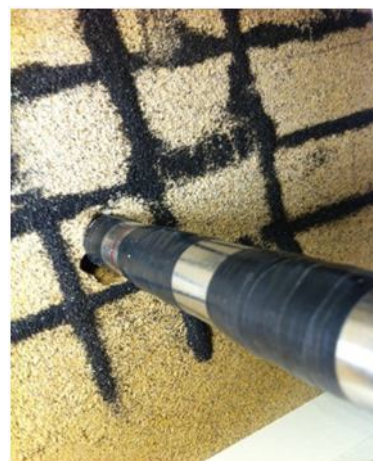
شکل ۱۹- خالی شدن خاک پشت شمع پس از آزمایش
