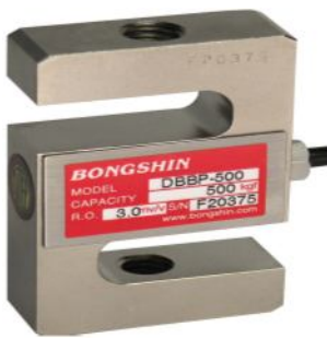
شکل ۱۲- تصویر نیروسنج S شکل مورد استفاده
