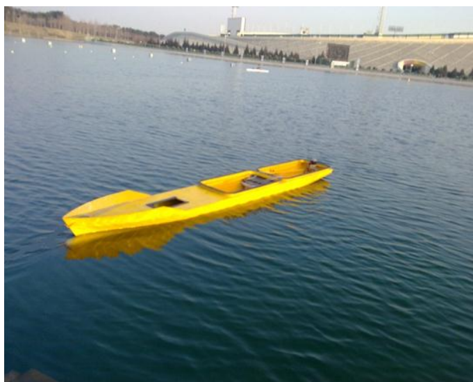
شکل ۳: مدل شناور KCS در حین تست در دریاچه آزادی
