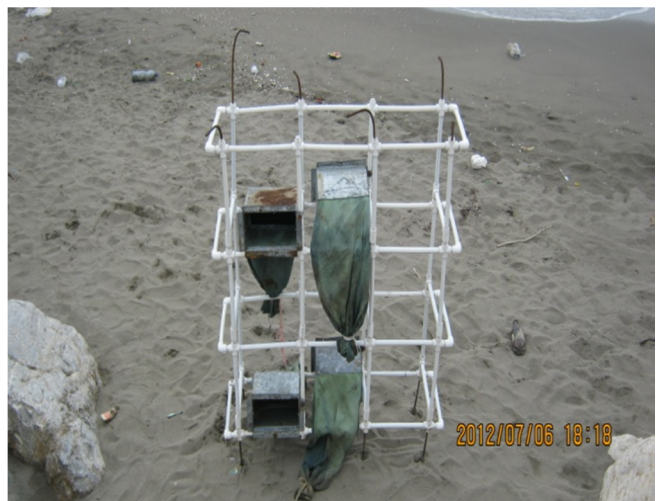
شکل ۱- تله گیر رسوب مورد استفاده در تعیین نرخ انتقال رسوب در ساحل شهر نور
