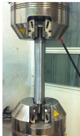
شکل ۲- نمایی کلی از آزمایش یک سویه فشاری
