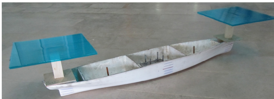
شکل ۳- تصویر مدل سری ۶۰ با ضریب ظرافت بدنه ۰/۶
