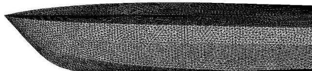
ج) شبکه‌بندی غیرساختاریافته روی بدنه شناور
