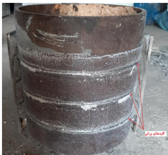
شکل ۸ - کلید برشی ایجاد شده بر روی نمونه به کمک جوشکاری
