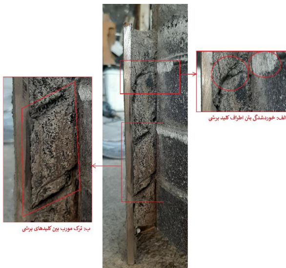
شکل ۱۲ - مود شکست بتن الیافی (الف) خورد شدگی بتن اطراف کلید برشی (ب) ترک مورب برشی
