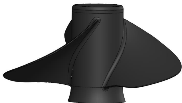
شکل ۵- هندسه پروانه Sharrow 2
