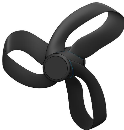
شکل ۳- هندسه پروانه Sharrow 1
