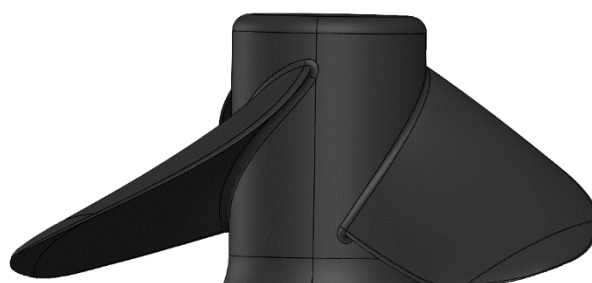
شکل ۳- هندسه پروانه Sharrow 1
