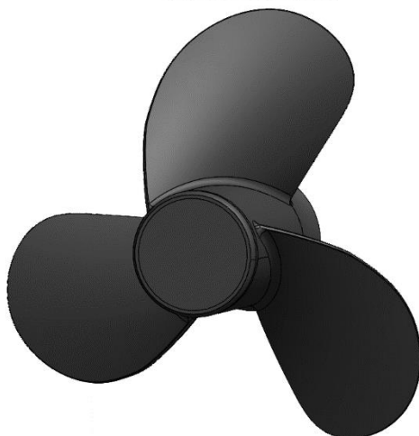
شکل ۶- هندسه پروانه Standard
