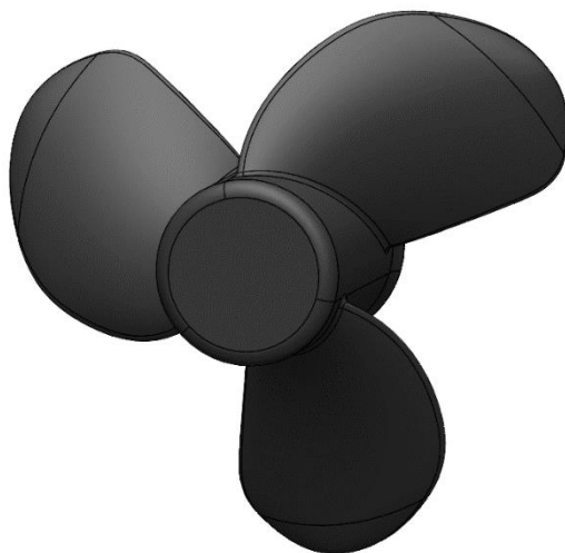
شکل ۴- هندسه پروانه B-Series
