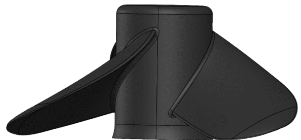
شکل ۳- هندسه پروانه Sharrow 1
