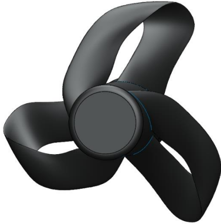
شکل ۵- هندسه پروانه Sharrow 2
