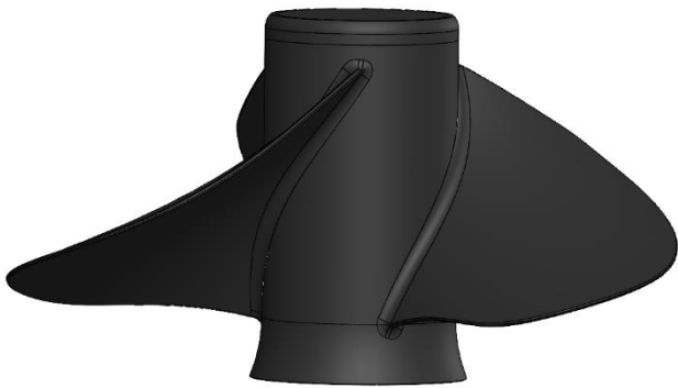
شکل ۵- هندسه پروانه Sharrow 2
