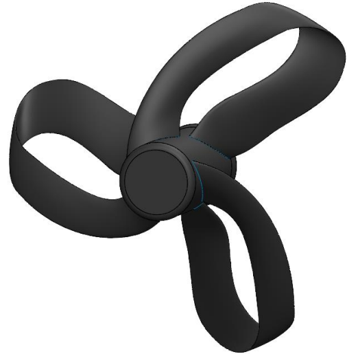
شکل ۳- هندسه پروانه Sharrow 1
