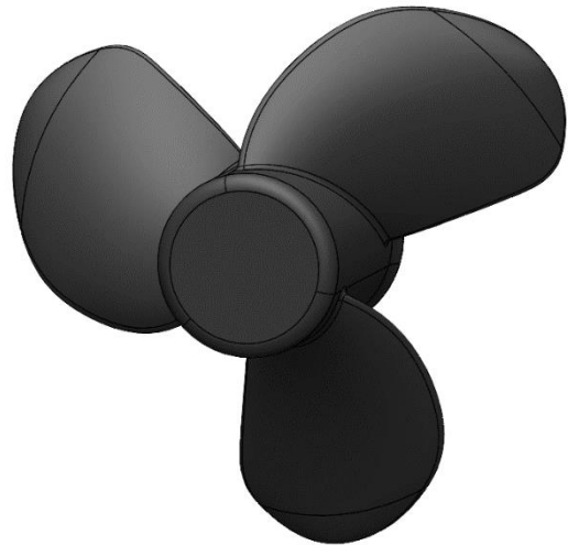
شکل ۴- هندسه پروانه B-Series
