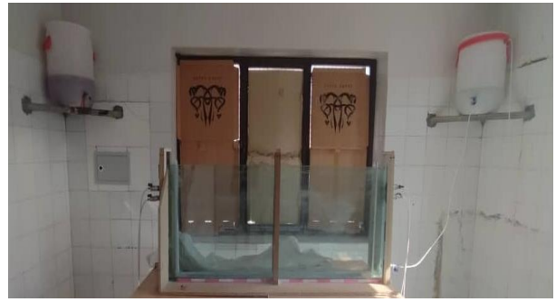
شکل ۱- نمایی از فلوم آزمایشگاهی و مخازن (بشکه‌های) هد ثابت.
