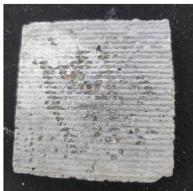
شکل ۲۱- تخریب لبه‌های برش خورده نمونه بتنی بعد از آزمایش
