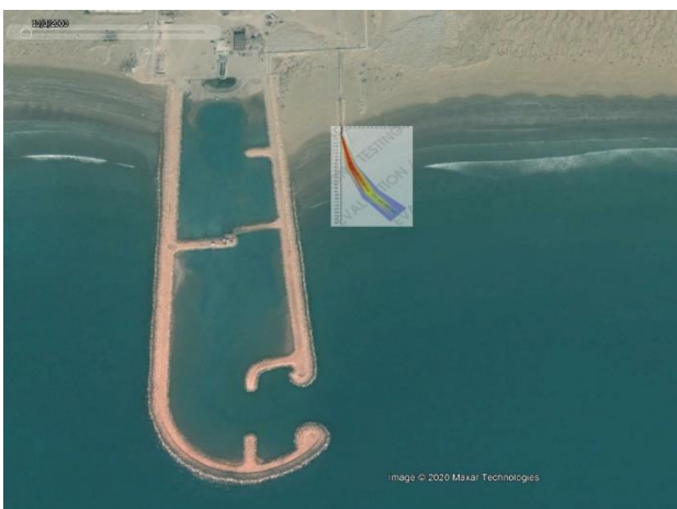
شکل ۸- الگوی پخش شوری برای دبی ۳ متر مکعب بر ثانیه با سرعت جریان ۰/۰۵۷ متر بر ثانیه
