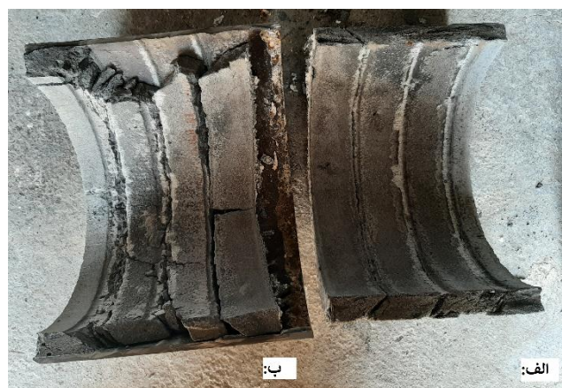
شکل ۱۳ - نمونه های پس از شکست (الف) بتن الیافی (ب) بتن بدون
