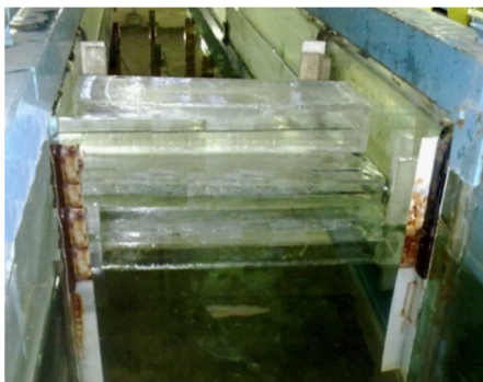
شکل ۵- نحوه مهار مدل موج‌شکن در فلوم آزمایشگاهی
