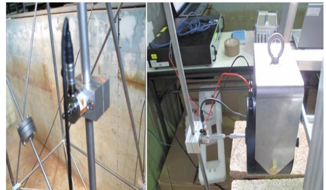
شکل ۲- ارتباط بین آمپلی فایر، لرزاننده الکترو دینامیکی، نیروسنج و سازه ی مدل
