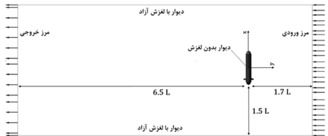
شکل ۱۲- میدان حل و شرایط مرزی در شبیه سازی های آزمون های کشش محوری و جانبی
