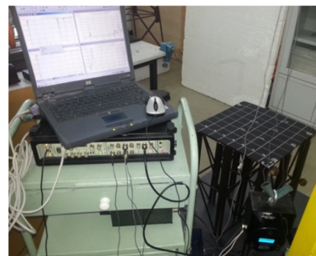
شکل ۱- چیدمان تجهیزات انجام آزمایش آنالیز مودال تجربی
