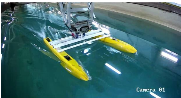
شکل ۱۴ - نمایی از تست مدل با وزن 20 \text{ kg} در سرعت 2.5 \text{ m/s}
