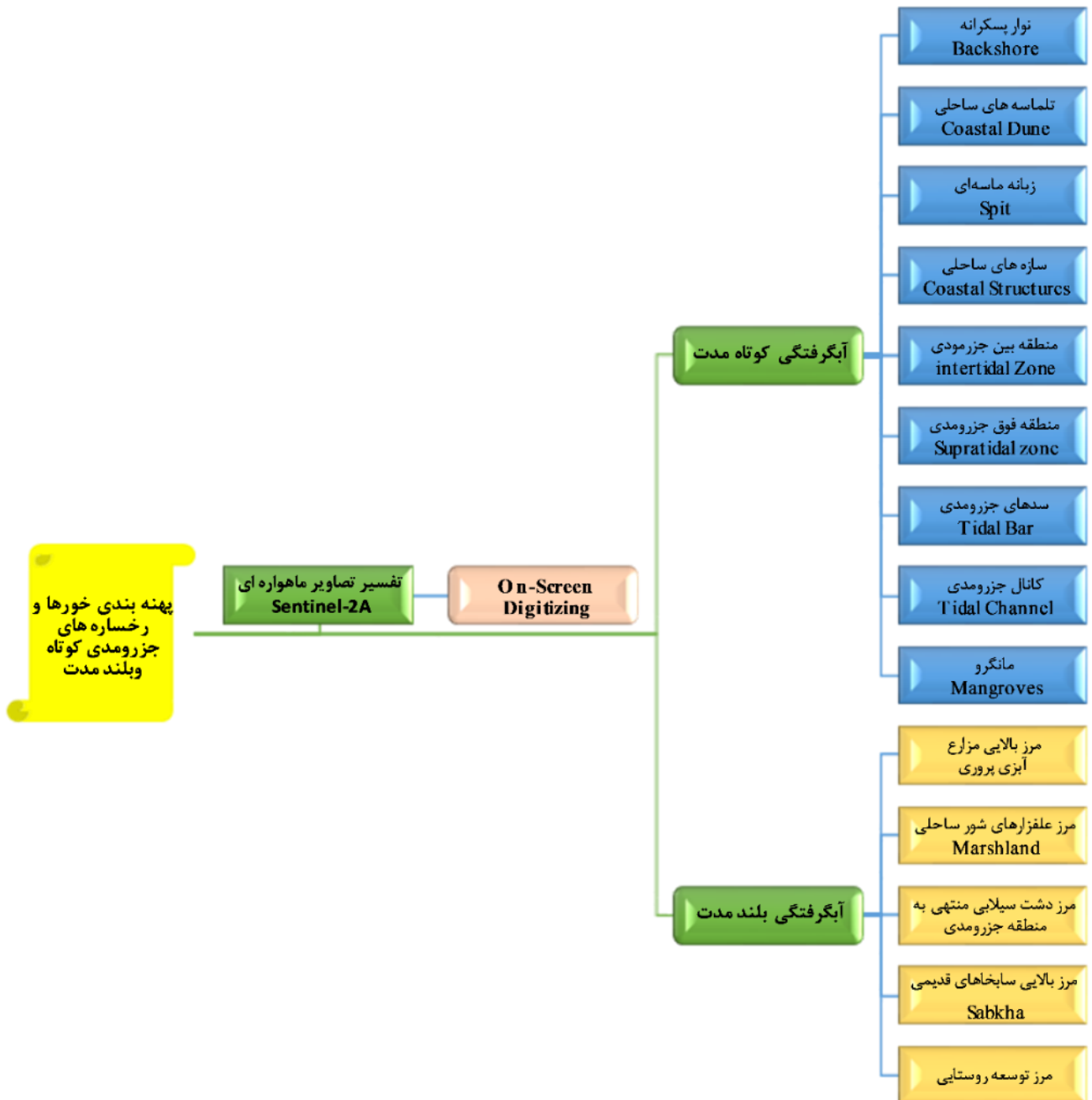
شکل ۲- روش پهنه‌بندی خورها و رخساره‌های جزرومدی کوتاه و بلند مدت منطقه ساحلی استان بوشهر
