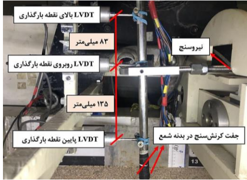
شکل ۸- تجهیزات رفتارنگاری و حس‌گرها
