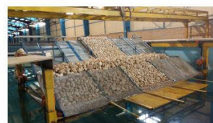
ج: لایه فیلتر و لایه نگهدارنده آرمور
