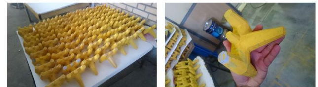
و: رنگ‌آمیزی آرمورها
