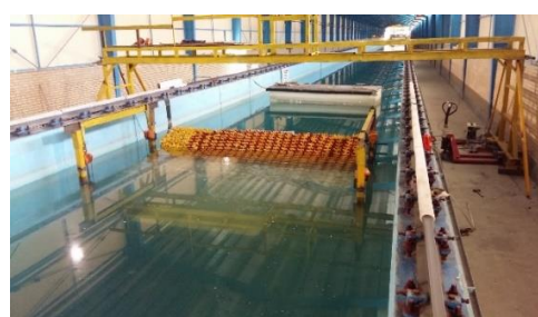
شکل ۱۲ - نمای نهایی از قرارگیری مدل فیزیکی در عمق ۱۰۸ سانتی‌متر
