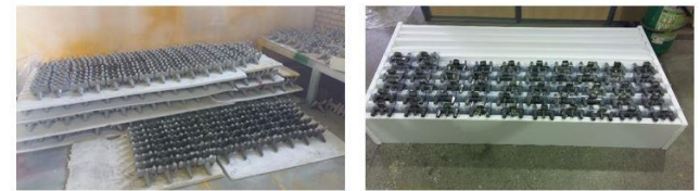
د: جداسازی آرمورها از قالب
