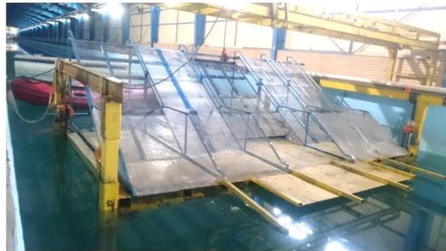
شکل ۱۰ - نمایی از توری‌های نگهدارنده مصالح در بخش‌های کناری مدل فیزیکی
