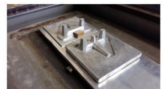
الف: قالب پایه به جهت ساخت قالب وکیومی
