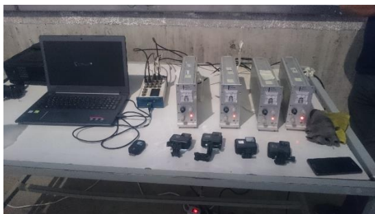
شکل ۱۳ - آمپلی‌فایرهای موج‌نگار، دوربین‌های ثبت تخریب لایه آرموری و سیستم کامپیوتری ثبت نتایج
