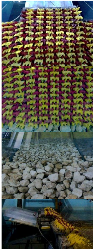
آزمایش شماره ۱۲ ( T_p=2.01 , H_s=27 , d=114 )
