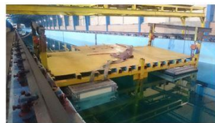
الف: برپایی زیرسازه فولادی در فلوم آزمایشگاهی
