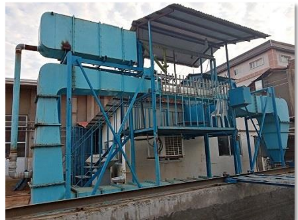
شکل ۲- نمایی از تونل آب سطح آزاد گروه انرژی‌های دریایی دانشگاه صنعتی نوشیروانی بابل
