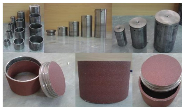
شکل ۶- تصاویر مدل‌های پی لبه‌دار با ابعاد و زبری مختلف
