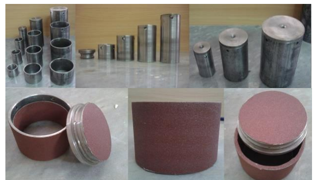
شکل ۶- تصاویر مدل‌های پی لبه‌دار با ابعاد و زبری مختلف
