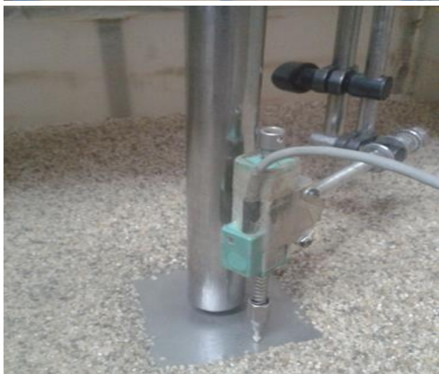
شکل ۷- تصاویر مدل، بارگذاری و اندازه‌گیری پاسخ مدل‌های پی لبه‌دار
