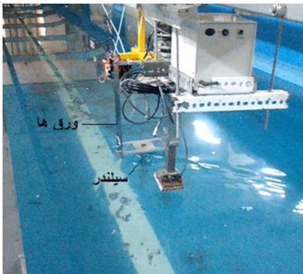
شکل ۷: مجموعه سیلندر به همراه ورق‌ها در حال تست در حوضچه
