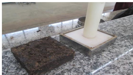
شکل ۸- نمونه خاک با سی درصد نفت به همراه چکش و قالب
