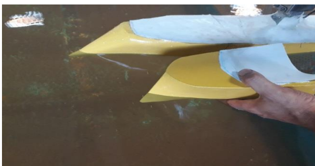
شکل ۵ - نمایش فرم هندسی سینه شناور با زوایای ۴۵ و ۶۰ درجه.
