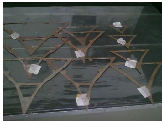
شکل ۳- نمایی از چند فریم عرضی ساخته شده به کمک دستگاه CNC
