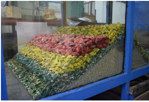
۵-د- اجرای کامل موج شکن سکویی چندلایه
