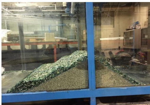
۵- ب- اجرای کلاس III موج شکن سکوی چندلایه
