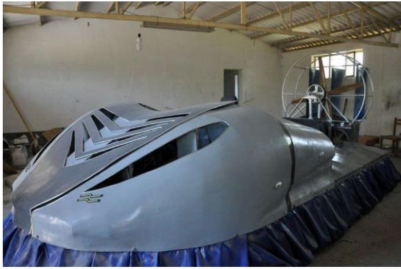
شکل ۳- نمونه اصلی هاورکرافت ساخته شده در دانشگاه مازندران
