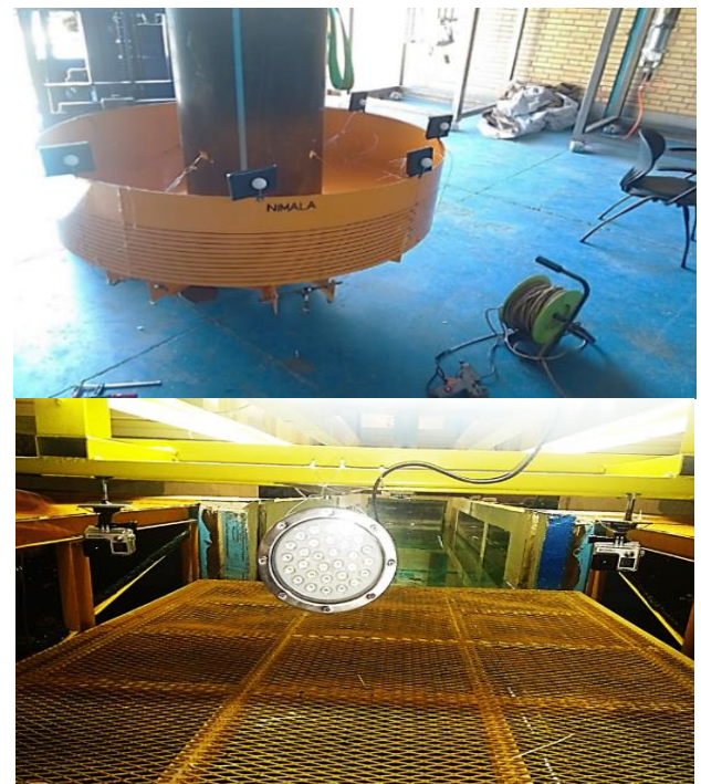
شکل ۱۴- نقاط مارکر سفید رنگ با زمینه تیره نصب شده بر روی SPM (تصویر بالا) و نمایی از قرارگیری دو دوربین و پروژکتور هنگام تصویربرداری از SPM (تصویر پایین)
