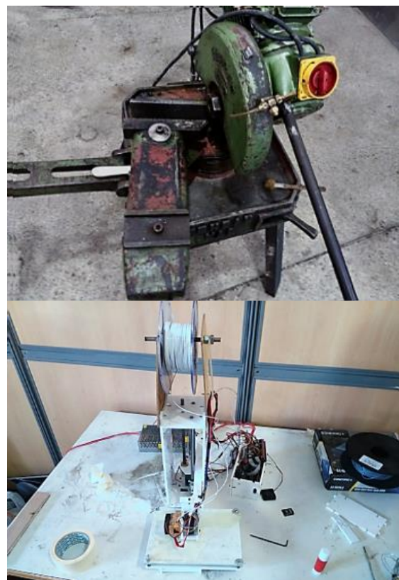
شکل ۱۶ - دستگاه برش مورد استفاده برای برش میله های المان کالیبراسیون سه بعدی (تصویر بالا) و پرینتر سه بعدی در حال پرینت اتصالات اصلی المان کالیبراسیون سه بعدی (تصویر پایین)
