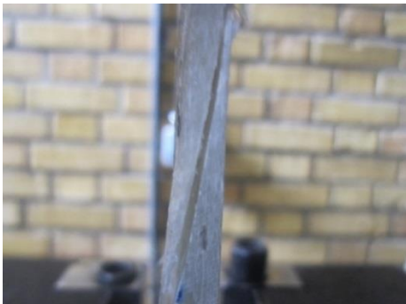
شکل ۱۵- نحوه شکست نمونه‌ها با شیب \frac{1}{6}
