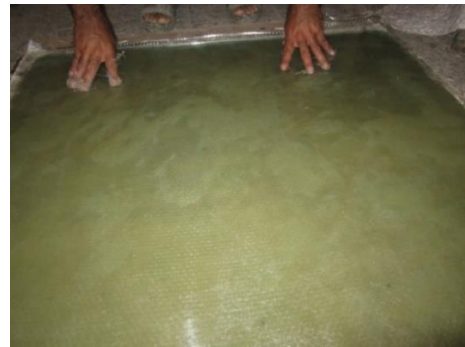
شکل ۴- گذاشتن شیشه رویی پس از اتمام لایه‌گذاری.
