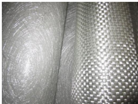
شکل ۳- لایه حصیری و رندم برای لایه‌چینی
