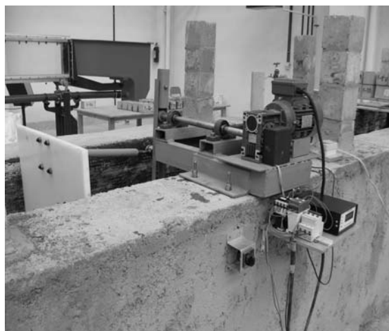
شکل ۱- الف) دستگاه موج‌ساز مکانیکی طراحی و ساخته شده
