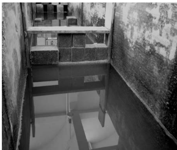
شکل ۱- ب) محل قرارگیری نمونه‌ها در ناحیه پاششی
