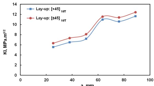
شکل ۱۱- اثر کامپوزیت بور/اپوکسی با چیدمان  $45^\circ$  و  $\pm 45^\circ$  بر ضریب شدت تنش در استوانه ترمیم شده
