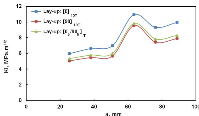
شکل ۱۰ - اثر کامپوزیت بور/اپوکسی با چیدمان  $0^{\circ}$  و  $90^{\circ}$  درجه بر ضریب شدت تنش در استوانه ترمیم شده
