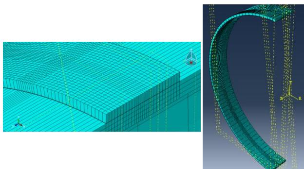
شکل ۶ - نمایش مش بنده اجزا لوله ترک‌دار ترمیم شده
