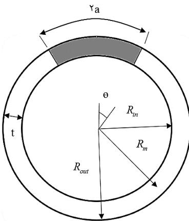
شکل ۱ - لوله ترکدار حاوی ترک محیطی راه به در تمام عمقی
