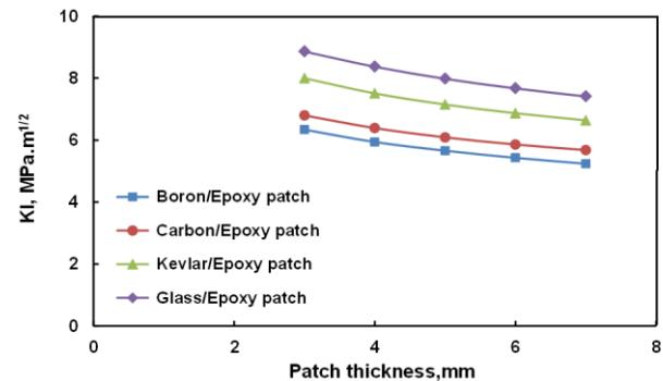
شکل ۸ - اثر ضخامت وصله‌های کامپوزیتی بر ضرایب شدت تنش استوانه ترک دار با طول ترک  $50/8\text{ mm}$
