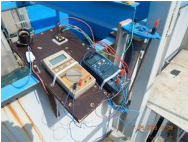
شکل ۵: الف) مجموعه کامل مبدل انرژی موج مستقر در استخر موج (ب) مجموعه چرخ دنده، چرخ طیار و ژنراتور (ج) مجموعه رنوستا و مولتی متر-ها برای ثبت ولتاژ و جریان تولیدی توسط سامانه
