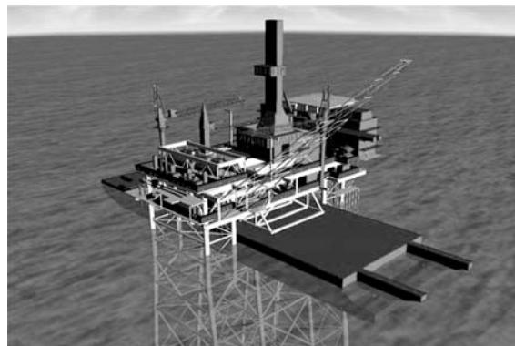
شکل ۱- سیستم شناور سازی(**Float over**) برای یک سکو و مرحله بار اندازی عرشه از بارچ به جاکت
