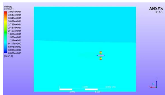
شکل ۹- نمایی از توزیع سرعت پروانه، H=2, J=0.9
