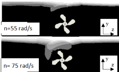
شکل ۱۵- کانتورهای نسبت حجمی (آب) حول پروانه در مقطع عرضی به ازای سرعت چرخشی پروانه ( J=0.45 )
