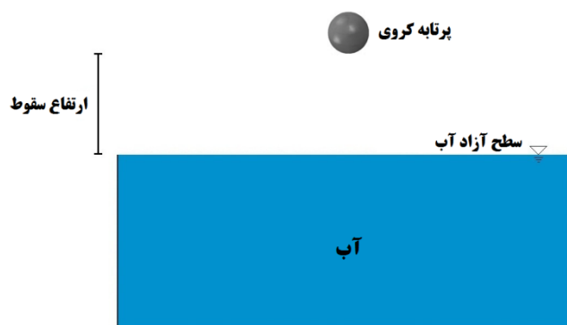
شکل ۴- شماتیکی از ارتفاع سقوط پرتابه کروی از سطح آزاد آب
