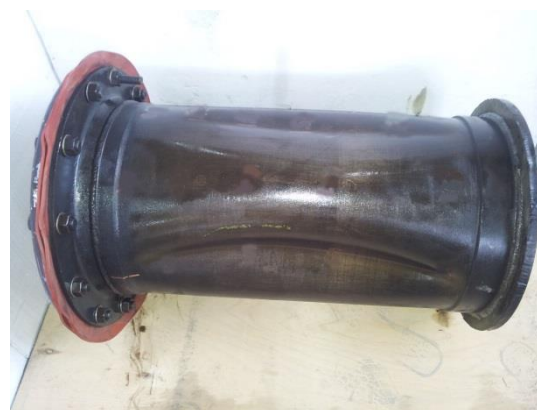
شکل ۱۷- نمونه فولادی بعد از کماتش و ضریب ۰/۴ در آزمایش
