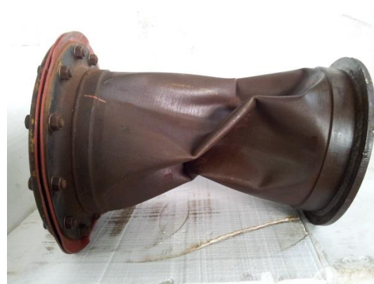
شکل ۱۸- نمونه فولادی بعد از پس کماتش
