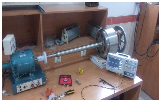
شکل ۱۳ - چیدمان تست موتور BLDC
