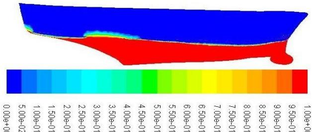
شکل ۹- رژیم خشک در پاشنه شناور مدل ۵۴۱۵
