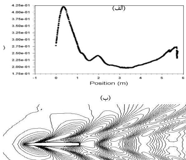
شکل ۱۰- مقایسه تغییرات امواج روی سطح آزاد و بدنه شناور در حالت خزه گرفتگی آهکی کم در فرود ۴۱°. (الف): پروفایل موج روی بدنه، (ب): انتشار موج در سطح آزاد
