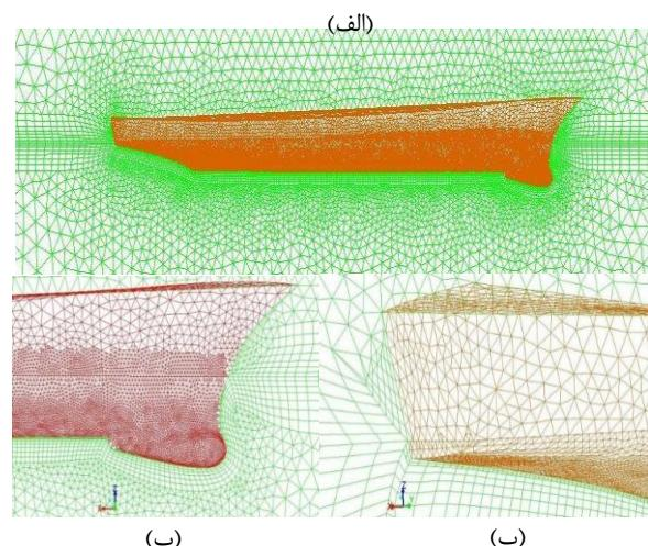
شکل ۲- نمایی از مش بنده شناور، (الف): شناور مدل، (ب): نمای نزدیک سینه شناور، (ب): نمای نزدیک انتهای شناور
