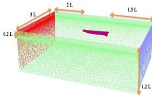
شکل ۱- نمایی از ابعاد دامنه حل و مش بنده آن
