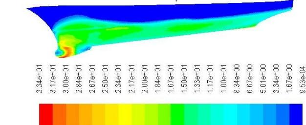
شکل ۱۵ - مقایسه تنفس برشی وارد بر بدن شناور با سرعت جریان آزاد  $30.71 \text{ m/s}$  در فرود  $41^\circ$ ، (الف): شناور در حالت خزه گرفتگی آهکی شدید، (ب): شناور با پوشش سیلیکونی، (پ): شناور با پوشش کوپلیمر مسی
