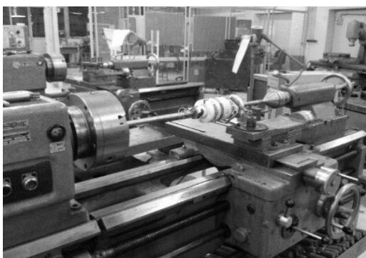
شکل ۲۱ - نصب سیستم اندازه گیری بر محور تعییه شده بر روی دستگاه ماشین تراش TN40
