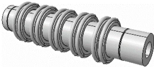
شکل ۱۲ - تصویر شماتیک نحوه‌ی قرار گیری آب بندها مابین محفظه‌های تفکیک شده‌ی بر روی محور دور
