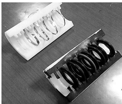
شکل ۱۳ - نحوه‌ی قرار گیری آب بندها بر روی محور دور
