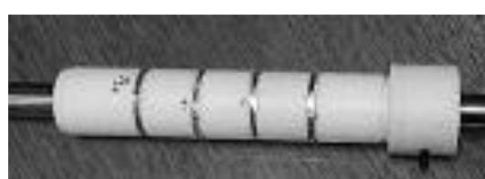
شکل ۱۰ - رویه‌ی داخلی مجهز به ورقه‌های مسی
