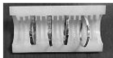
شکل ۱۱ - رویه ی خارجی مجهز شده به ورقه‌های مسی
