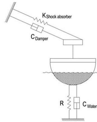
شکل ۲ - شمای کلی سیستم جرم، فنر، دمپر
