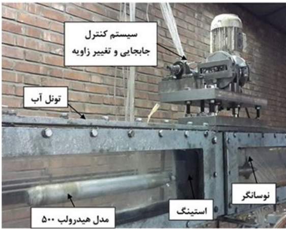
شکل ۱۴ - بخشی از تونل آب، مدل زیرسطحی و مکانیزم تولید مانورها
