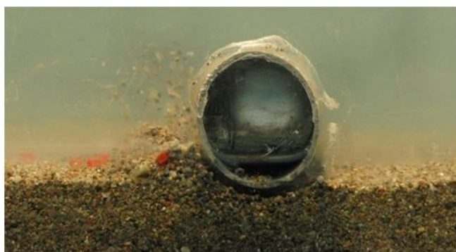
شکل ۵- لحظه‌ی خروج رسوبات از زیر لوله و شروع آبشستگی
