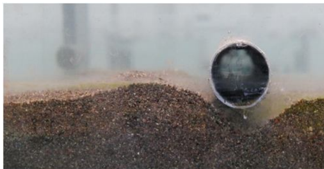
شکل ۱۲- تصویر مربوط به عرض نسبی ۰/۱۵ تیغه در لوله ۴ سانتی‌متر
