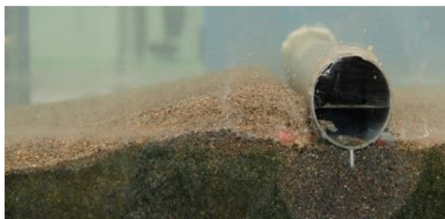
شکل ۱۷- تصویر مربوط به عرض نسبی ۰/۲ تیغه در لوله ۴/۹۵ سانتی‌متر
