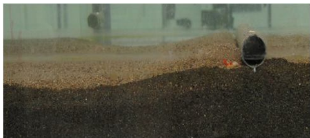
شکل ۸- تصویر مربوط به عرض نسبی ۰/۲ تیغه در لوله ۳/۱ سانتی متر
