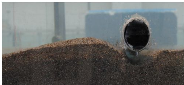
شکل ۱۶- تصویر مربوط به عرض نسبی ۰/۱۵ تیغه در لوله ۴/۹۵ سانتی‌متر
